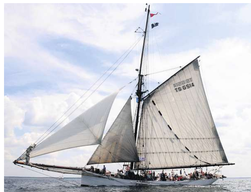
Der Haikutter „Nobile“ wurde 1919 in Lowestoft, England, gebaut und ist ein Einmast-Gaffel-Segler. Das Schiff hat Dimensionen, wie sie auf Rennyachten vor über 100 Jahren üblich waren: Gesamtlänge 38,5 Meter, Masthöhe 34 Meter, Segelfläche 510 Quadratmeter. FOTO: LUTZ ZIMMERMANN
